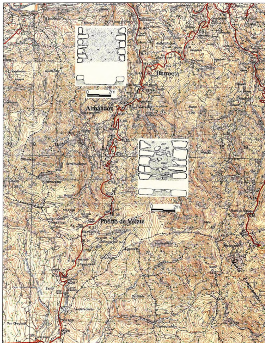
Figura 74.- Recorrido de la vía romana entre Velate y Berroeta. Anchura y sección de lo conservado.
